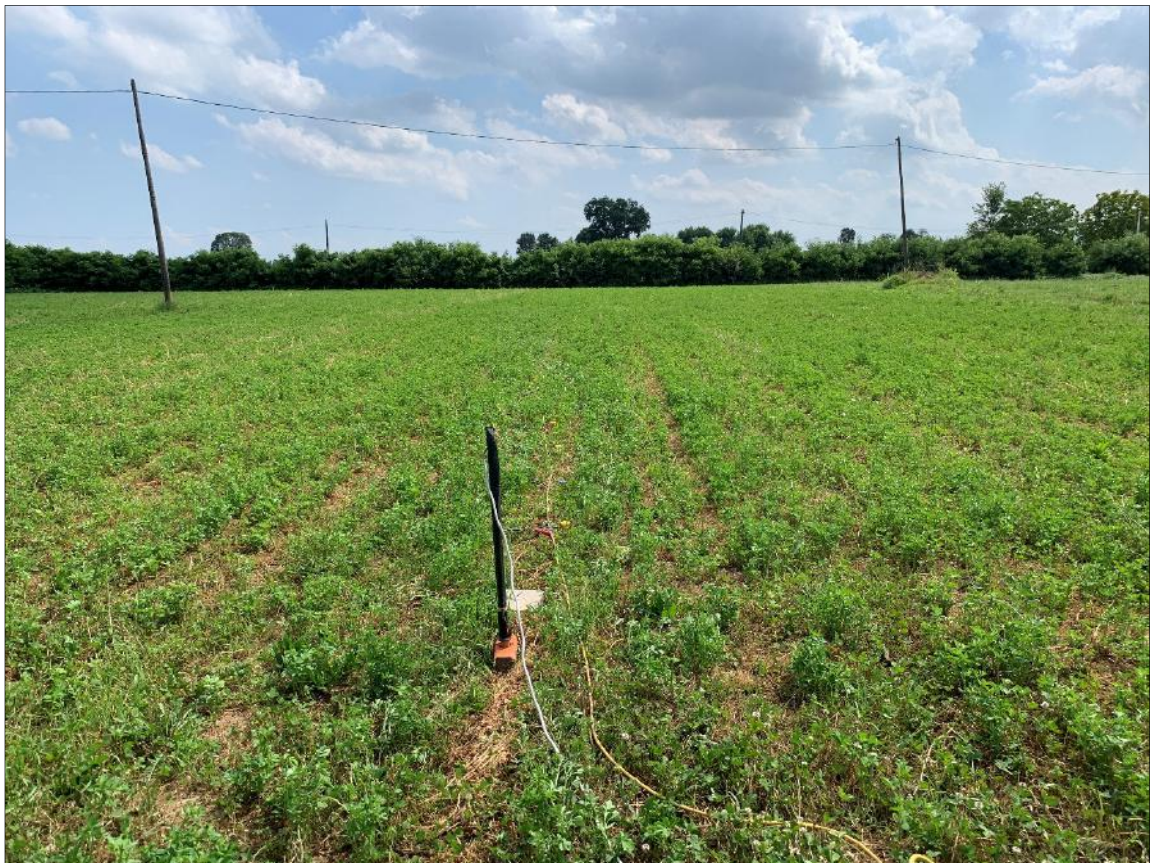
Fig. 11 Stendimento cavo con geofoni per esecuzione MASW
